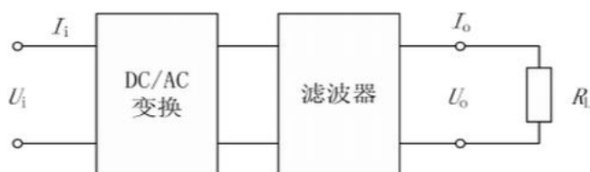
图 1 单相正弦波逆变电源结构框图
